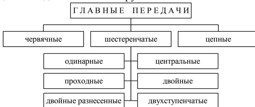
Рис. 68. Классификация главных передач
