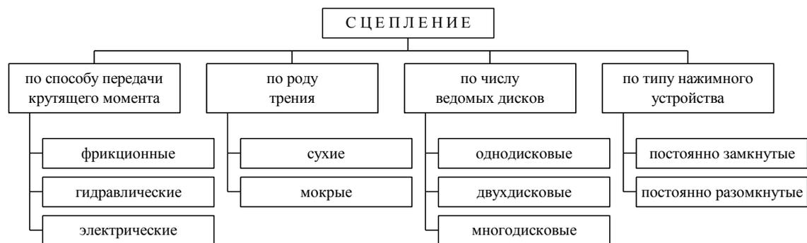
Рис. 1. Классификация автотракторных сцеплений
